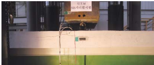
파괴형상 : 바닥판 콘크리트의 횡압축 파괴
